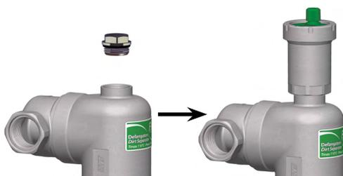
Per l'eventuale installazione della valvola di sfogo aria automatica, rimuovere il tappo superiore e avvitare la valvola. L'attacco superiore è da 1/2" per tutti i modelli di defangatore.
